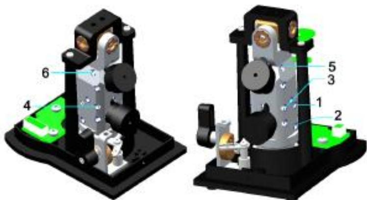
1. Si la línea de ajuste H es la H1, desenrosque el tornillo 2, seguidamente apriete el tornillo 1. Si la línea es la H2, desenrosque el tornillo 1, seguidamente apriete el tornillo 2, repita la operación hasta que la línea H este igual que la línea de referencia H0.
