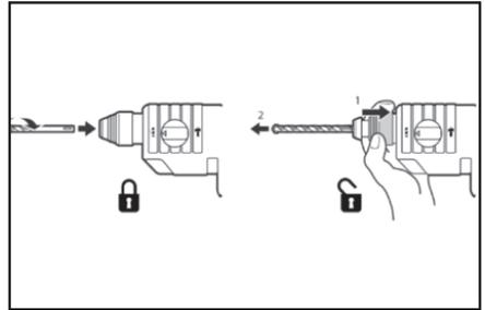
**!** El accesorio SDS-Plus requiere libertad de movimiento que provoca excentricidad cuando la herramienta está descargada; sin embargo, el accesorio se centra automáticamente durante el funcionamiento sin afectar la precisión de la perforación.
