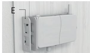
**2.** Accanto al distanziatore adesivo (H) posizionare il portabullone (E) sul telaio della porta. Il distanziatore segna la distanza minima tra la serratura e l'alloggiamento dei bulloni. Se entrambi non sono alla stessa altezza, è necessario utilizzare i pezzi (C) per montare la serratura nella fase 4.
