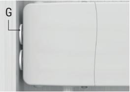
**6.** Entfernen Sie den Klebeabstandhalter. Legen Sie die Klebescheiben (G) auf die Schlossbolzen.
