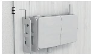
**2.** Platzieren Sie den Bolzenhalter (E) neben dem Klebeabstandhalter (H) am Türrahmen. Der Abstandshalter zeigt den Mindestabstand zwischen dem Schloss und dem Bolzenhalter an. Wenn die beiden Teile nicht auf der gleichen Höhe sind, müssen Sie in Schritt 4 die Unterlegscheiben (C) verwenden, um das Schloss zu unterlegen.
