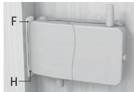
**2.** À côté du distanciateur adhésif (H) placez la plaque de la gâche (F) sur le cadre de la porte. Le distanciateur indique la distance minimale entre la serrure et la gâche. Si les deux ne sont pas sur la même hauteur/profondeur, vous devez utiliser les sous-pans (C), afin d'ajuster la serrure lors de l'étape 4.
