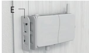
**2.** À côté du distanciateur adhésif (H) placez le cadre de la gâche (E) sur le cadre de la porte. Le distanciateur indique la distance minimale entre la serrure et la gâche. Si les deux ne sont sur la même hauteur/profondeur, vous devez utiliser les sous-pans (C) afin d'ajuster la serrure lors de l'étape 4.
