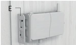
**2.** Ao lado do separador adesivo (H), coloque o alojamento das trancas (E) sobre o aro da porta. O separador marca a separação mínima entre a fechadura e o alojamento das trancas. Caso ambos não estejam à mesma altura, deverá utilizar as peças (C) e (D) para aplicar um calço na fechadura, no passo 4.
