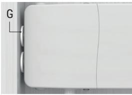
**6.** Rimuovere il distanziatore adesivo. Posizionare i dischi adesivi (G) sui bulloni della serratura.
