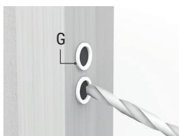
**7.** Estenda as trancas e os discos adesivos ficarão colados à estrutura da porta. Fure os orifícios centrais do disco colado à estrutura, com ferramentas adequadas segundo o material. Utilize o disco (G) como molde para perfurar os orifícios. Nunca ultrapasse as dimensões do molde.
