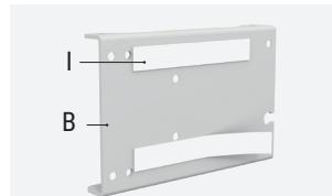
**3.** Fissare le strisce adesive (I) sul retro della piastra di supporto (B) o sugli spessori (C), per posizionarla correttamente sulla porta prima della foratura.
