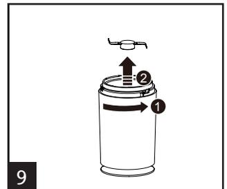
Fig. 1 Coloque las cuchillas girándolas en sentido horario. Tenga precaución cuando manipule las cuchillas
