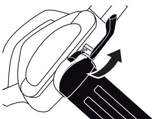
5. Inserire il tubo del sacchetto all'entrata dell'aria del motore e fissarlo bene alla relativa connessione (A), collegarlo al tubo di aspirazione.
