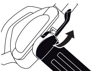
5. Εισάγετε τον σωλήνα του σάκου στην είσοδο αέρα και περιστρέψτε μέχρι να φτάσετε στο τέρμα του σπειρωμάτος (A) και σφίξτε στον σωλήνα αναρρόφησης (B).
