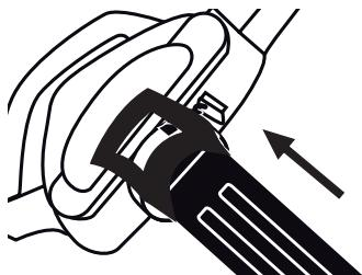
4. Vissez dans le sens des rainures jusqu'au fond. Une fois finie, doit se débloquer pour fixer le tuyau de soufflage.
