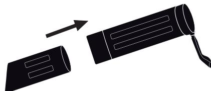
2. Ouvrez le capot du ventilateur en débloquant et, tournant le couvercle
