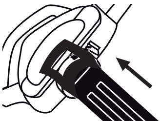
3. Gire siguiendo la ranura hasta que el anclaje llegue a su tope. Una vez terminado este procedimiento, se debe bloquear, para así fijar la unión del tubo del saco.
