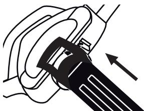
4. Gire siguiendo la ranura hasta que el anclaje llegue a su tope. Una vez terminado este procedimiento, se debe bloquear para así fijar la unión del tubo del saco.
