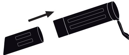
2. Abrir la cubierta del ventilador desbloqueando y girando la tapa.
