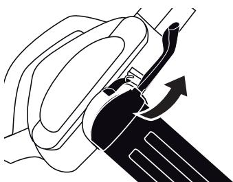
5. Insérez le tube du sacdans la entrée d'air et tourner jusqu'au fond de la fente (A). Fixez-le au tube d'aspiration (B).
