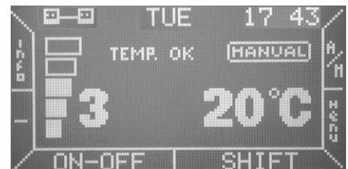
**A / M** A= automático M= manual, en proximidad de la tecla 6, si se pulsa después de la tecla 4 ( SHIFT ) permite seleccionar el funcionamiento en manual o automático.
