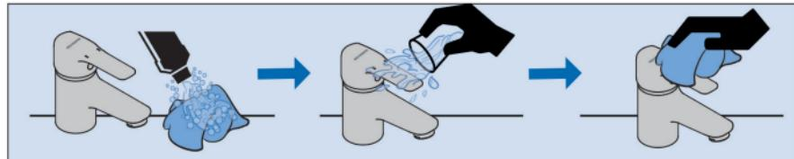
**LIMPIEZA DE LA RANURA DE TEMPORIZACIÓN****TIMING SLOT CLEANING****Ranura de temporización:**
