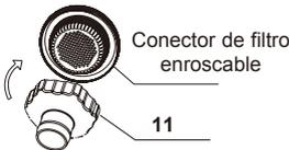
Enrosque el adaptador de manguera B (11) al conector de filtro enroscable desde el interior de la pared de piscina.
