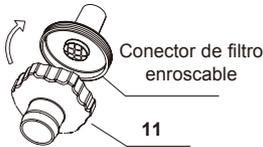
Enrosque el adaptador de manguera B (11) al conector de filtro enroscable desde el interior de la pared de piscina.
