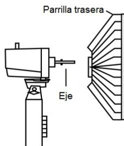
Deslice las aspas en el eje del motor.
