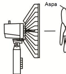
Enrosque la tapa de aspas en el eje girando en el sentido de las manecillas del reloj.
